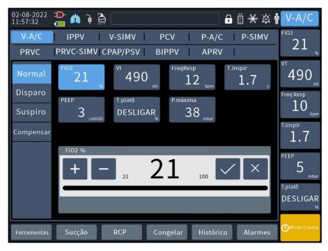
Figura 41 Definição dos parâmetros da ventilação
