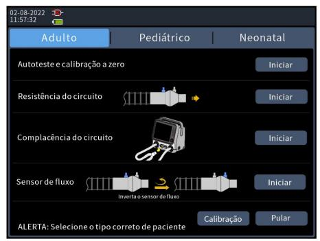
Figura 37 Interface de calibração do início
