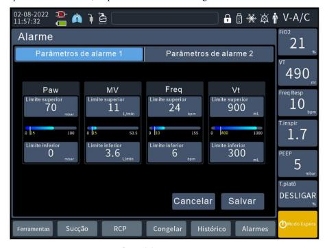
Figura 36 Limite do alarme
