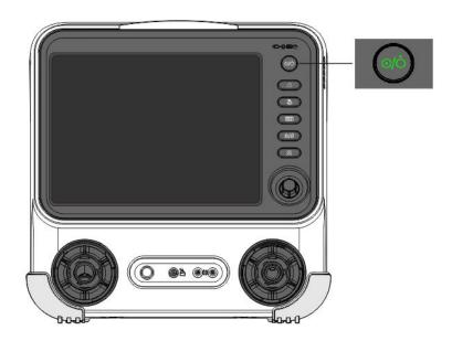
Figura 56 Desligue o ventilador
