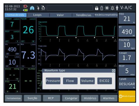
Figura 17 comutação de forma de onda
